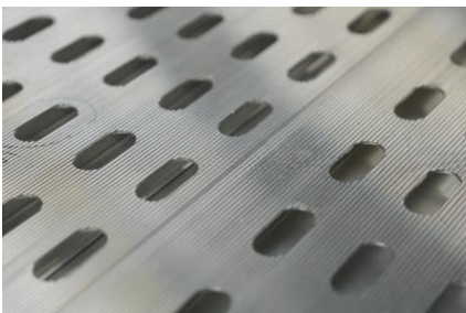
LDX-Boden (Fertigungsbedingt ungleichmäßiges Lochbild)
